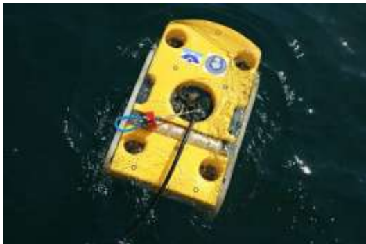
Рис. 7. Підводний апарат, підрулюючий комплекс якого організований за чотирьоххальною схемою
