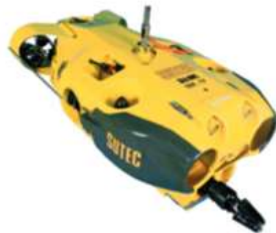
Рис. 2. Підводний апарат з рушійним комплексом, який організовано за двохвальною схемою
