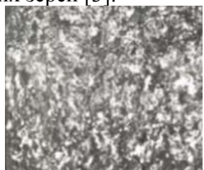
Рисунок 1 – Структура анода, отриманого методом безперервного "стрічкового" литва (а) і структура анода, відлитого у виливниці (б) [3]
